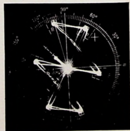
Fig. 46. Oscillogram waarin een differentiële fasefout zichtbaar is. Geel en cyaan worden voorgesteld door twee vectoren (ca. 2°), terwijl rood en blauw normaal worden weergegeven door twee elkaar dekkende vectoren.
